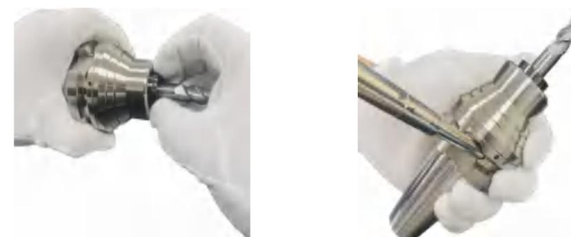
②ツールホルダーへコレットを差し込み、時計回りにねじ込み固定します。
