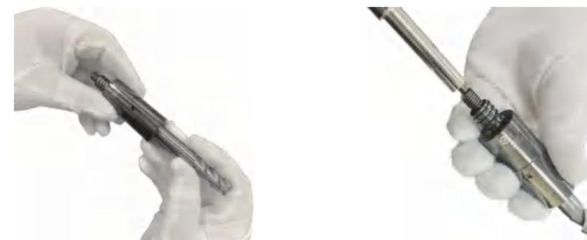
①コレットへツールを挿入しツールの長さを調整してください。
